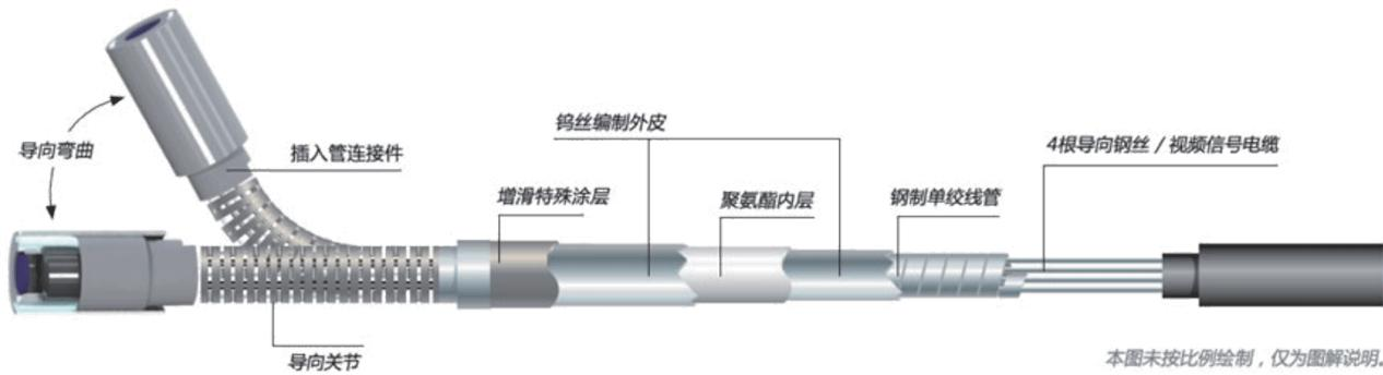
美泰电子视频内窥镜采用间接目视检测原理，利用探头顶端的CMOS图像传感器实时采集狭小空间内表面的图片信息并通过插入管内的视频信号电缆将数字信号传输至仪器主机从而实现图像的显示和存储，装有图像传感器的探头通过导向关节与插入管连接，导向关节可通过内置的导向钢丝在机械装置的控制下360°自由转动方便图片传感器实时拍摄传输图片资料。
